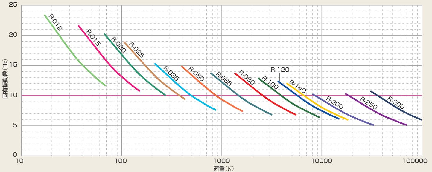
丸型防振ゴム…防振ゴムとして最も一般的な製品で小～大荷重までに向きます。また固有振動数は8～20Hzが中心となっています。
