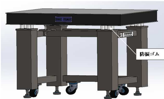
例) 防振ゴムを使用した除振台
