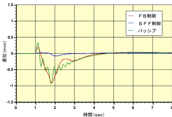
図3 応答回転変位測定例
