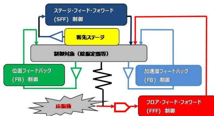
図1 アクティブ除振台の各種制御方式
